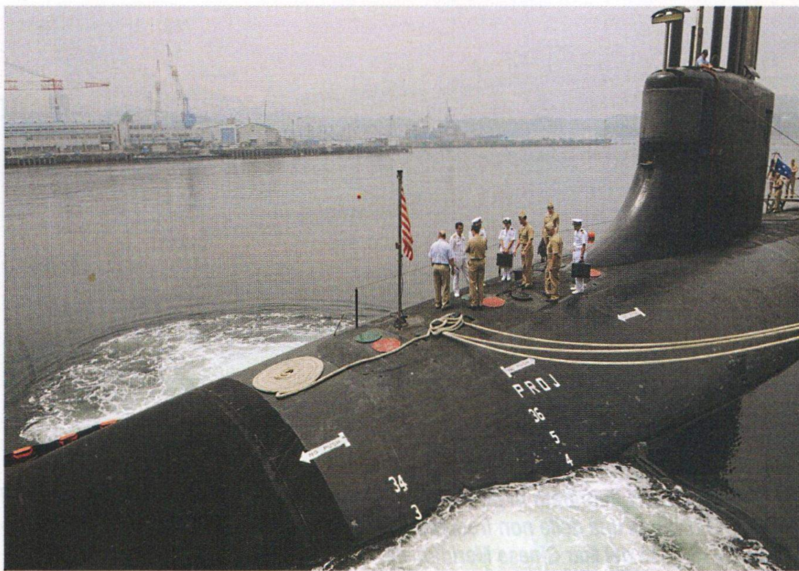
Durante la sosta del SEAWOLF nel porto giapponese di Yokosuka effettuata nell'estate 2013, a una delegazione della Marina Giapponese viene mostrato l'esaurimento delle casse zavorra di prora mediante aria a bassa pressione.
