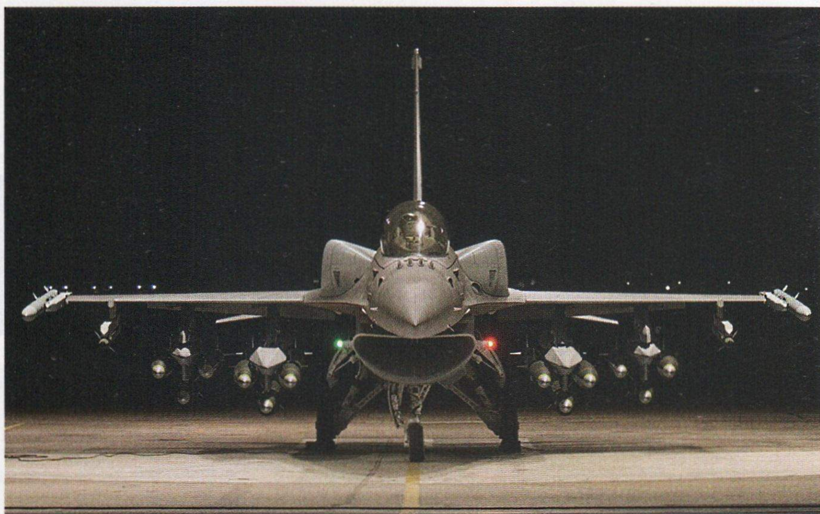
Ben visibili su questo F-16 i 2 serbatoi conformal nella parte superiore della fusoliera.
