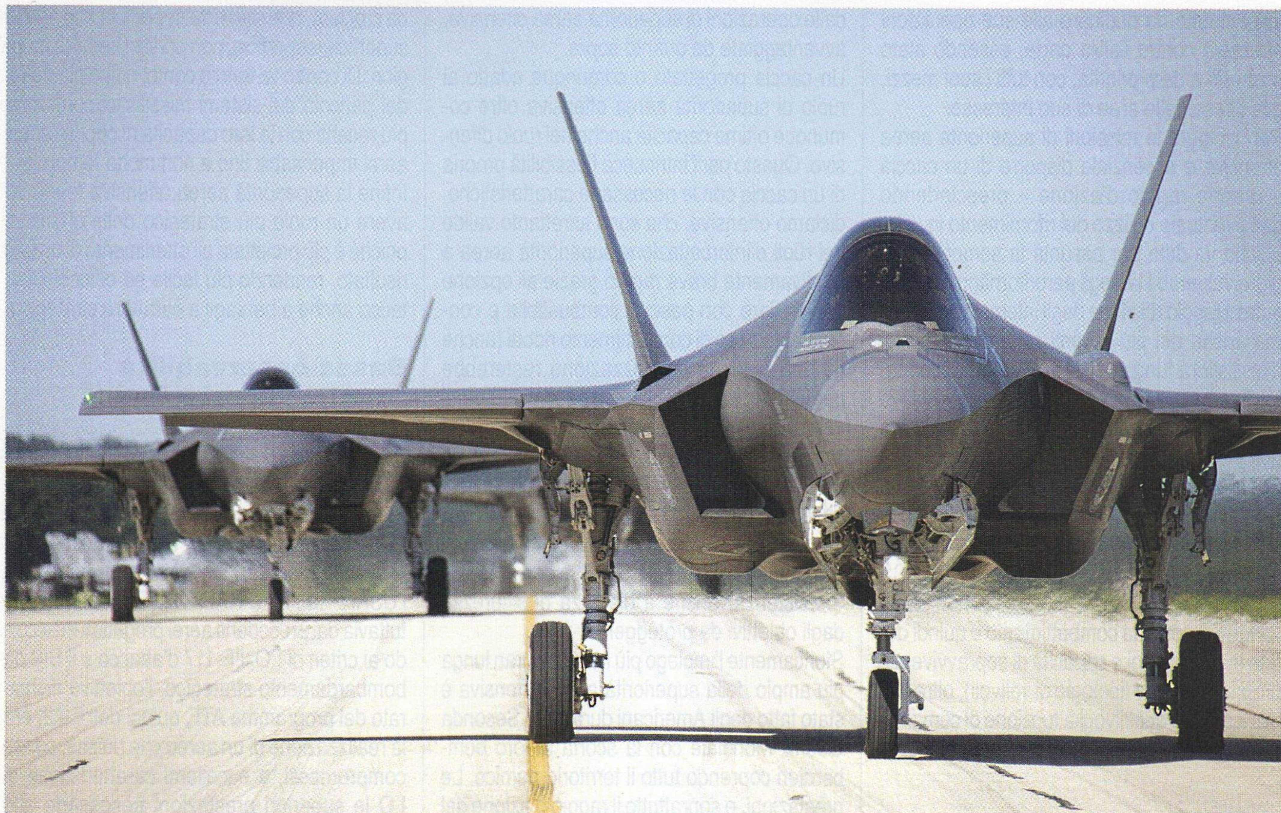
Due F-35A LIGHTNING II in rullaggio. Ben evidenti, sul velivolo in primo piano, le prese d'aria tipo DSI (Diverterless Supersonic Inlet).
