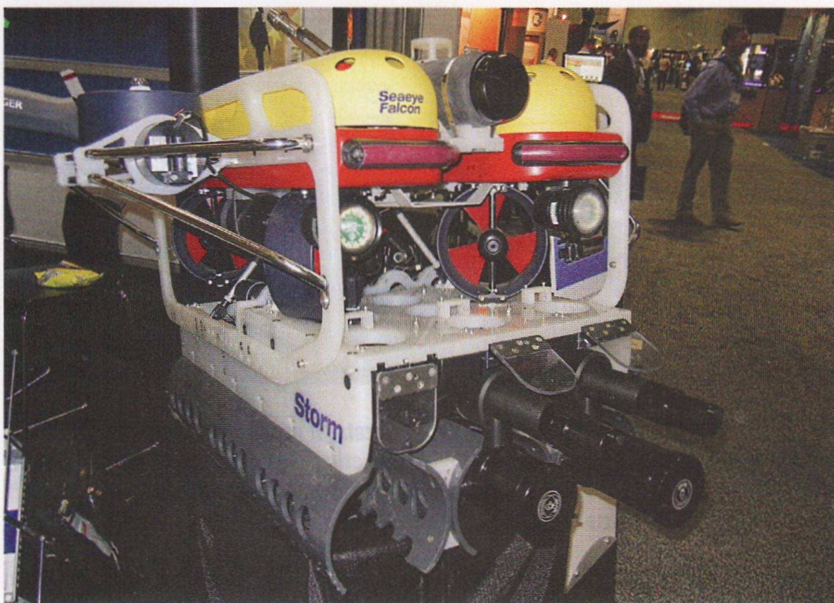
La Saab ha proposto un sistema economico detto Multi-shot Mine Neutralisation System, (MuMNS) equipaggiato con 3 cariche, per eliminare più mine durante un'unica sortita. Il magazzino (STORM) è intercambiabile e può essere impiegato su un gran numero di veicoli.
