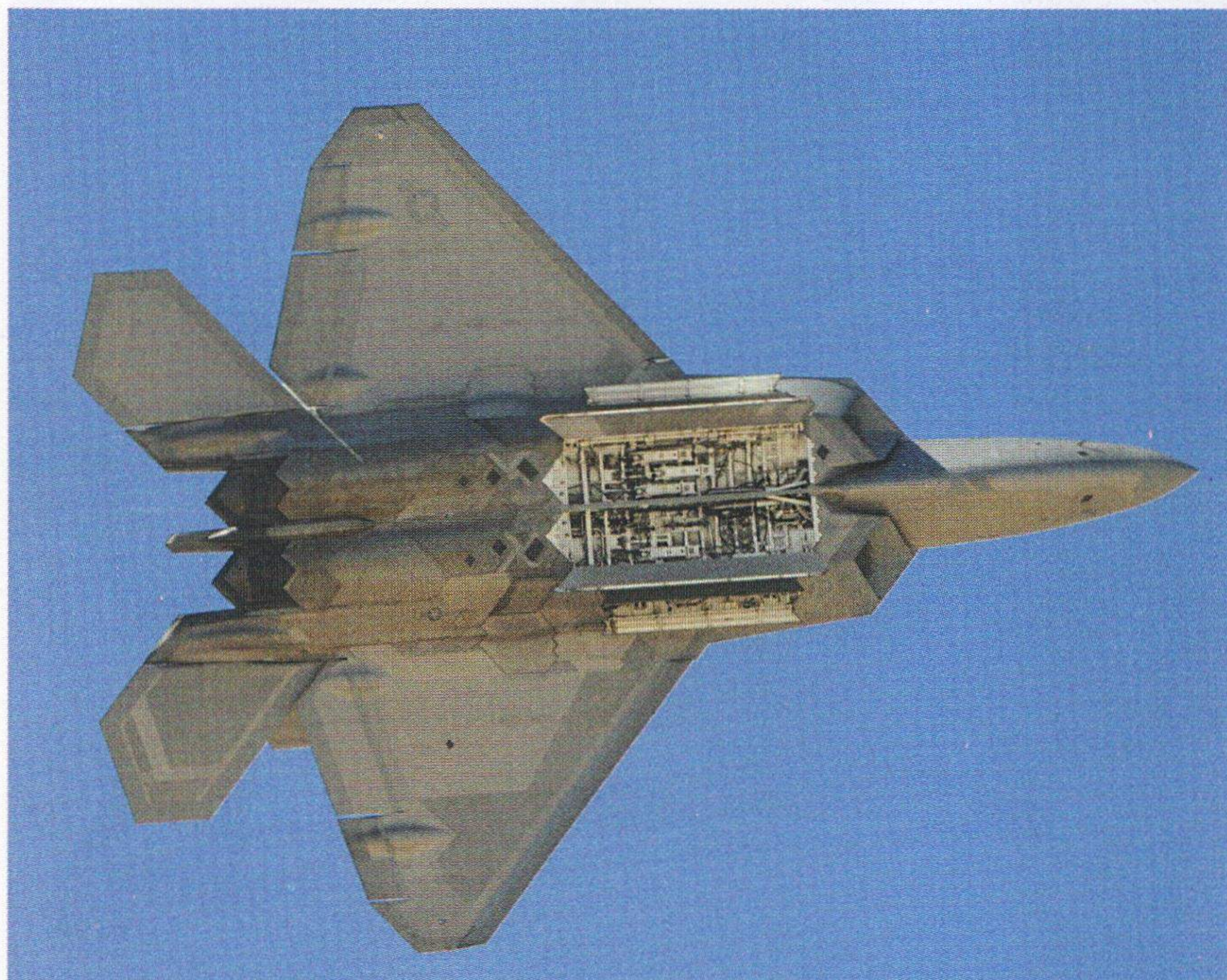
Un F-22 RAPTOR con i vani armamenti aperti. L'F-22 è l'unico velivolo in grado di trasportare 8 missili nei vani bombe.
