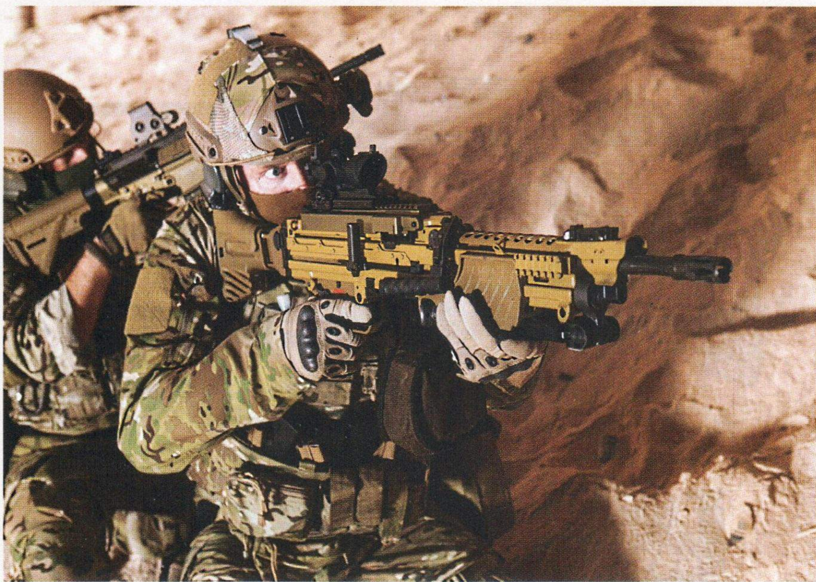
La Heckler & Koch MG-4 è una LMG calibro 5,56x45 presentata nel 2001. La nuova HK MG-5 riprende parecchie soluzioni impiegate in quest'arma.
