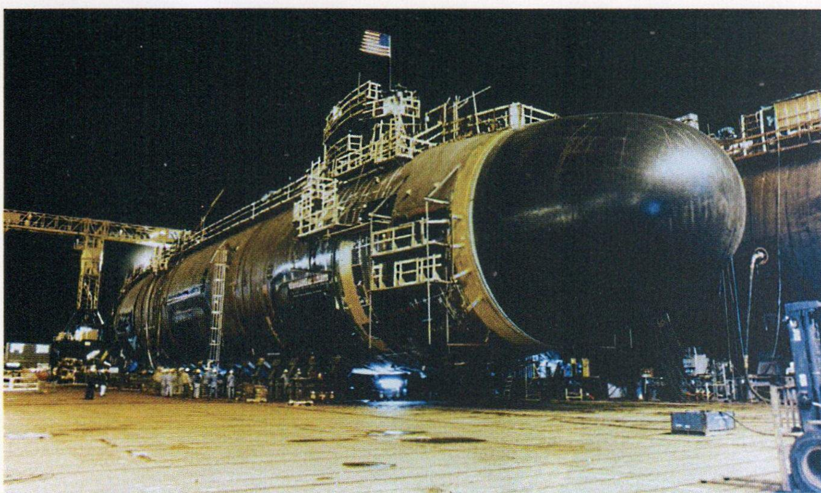
Il sottomarino SEAWOLF, eponimo della classe, durante le ultime fasi dell'allestimento nei cantieri Electric Boat di Groton (Foto Electric Boat).
