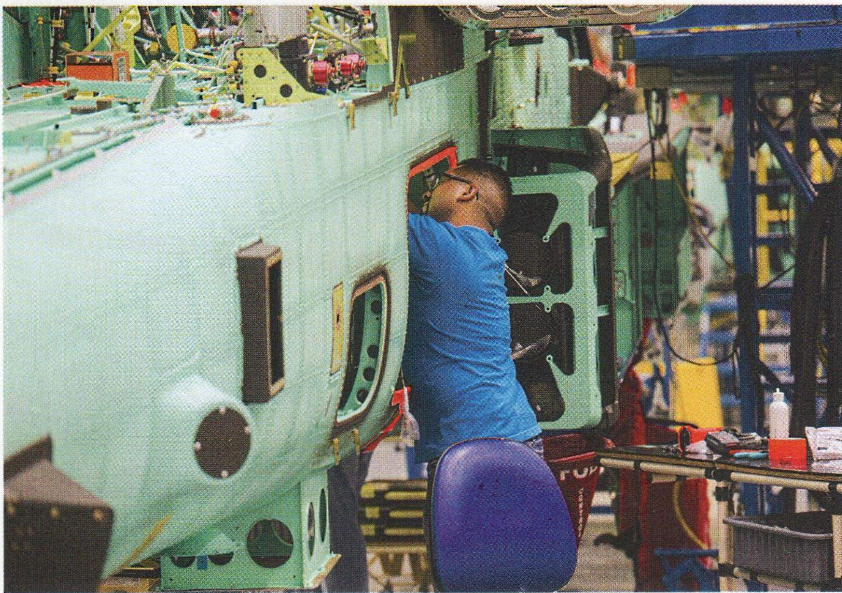
Un tecnico al lavoro su una cellula di AH-64. Lo stabilimento di Mesa ha una capacità produttiva di 7 macchine al mese.
