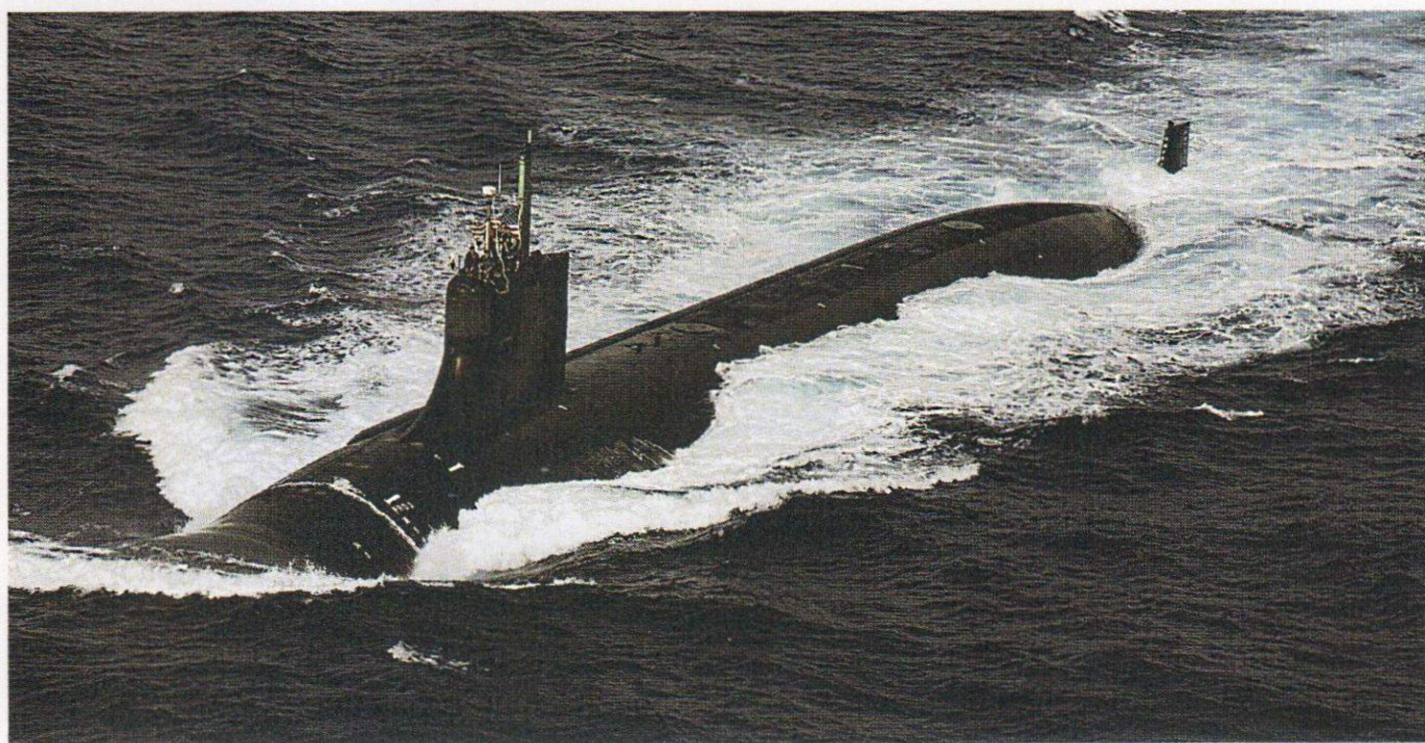
Il SEAWOLF in superficie: la creazione di un'onda di dimensioni relativamente generose indica l'attitudine del battello a operare peculiarmente in immersione.
