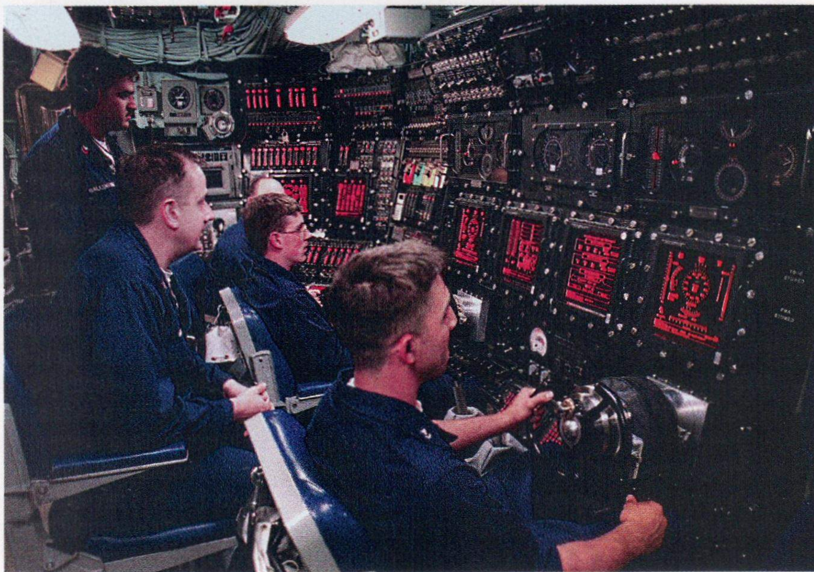
La zona della camera manovra del SEAWOLF destinata alla gestione della piattaforma: in primo piano, la console per il governo del battello.
