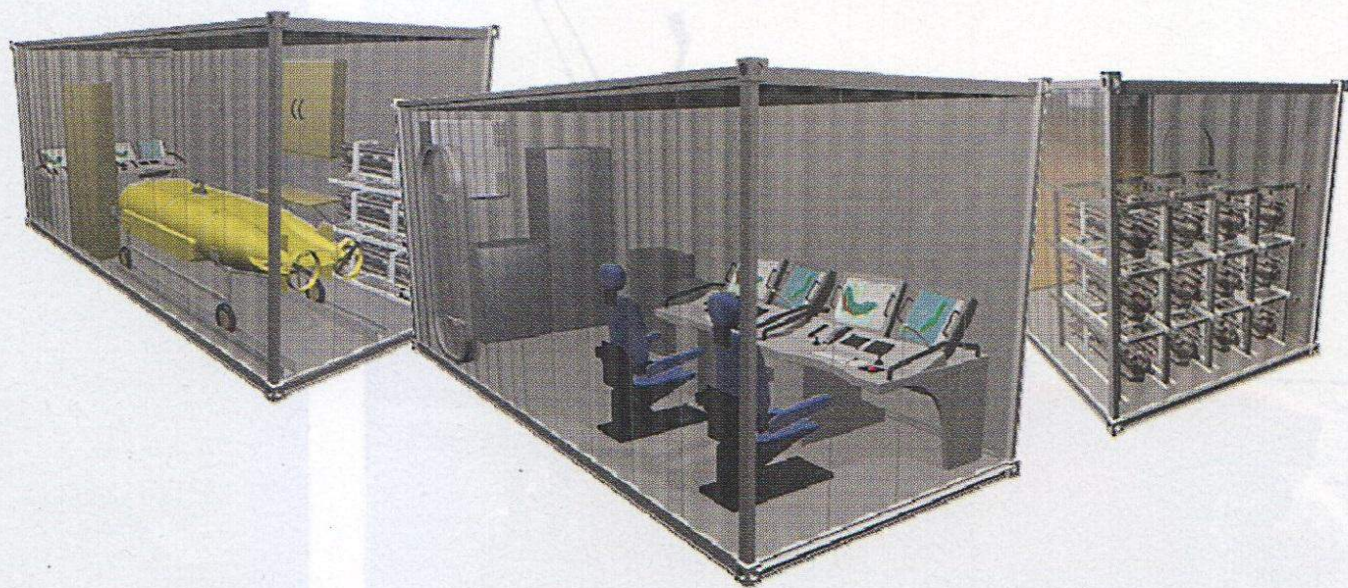
Il sistema modulare della Atlas comprende veicoli di vario tipo (qui un AUV SEA OTTER con side scan sonar e numerosi EMDV SEA FOX) ed un sistema di comando e controllo C-IMCMS. Può essere imbarcato su mezzi di opportunità, o posizionato su un molo.
