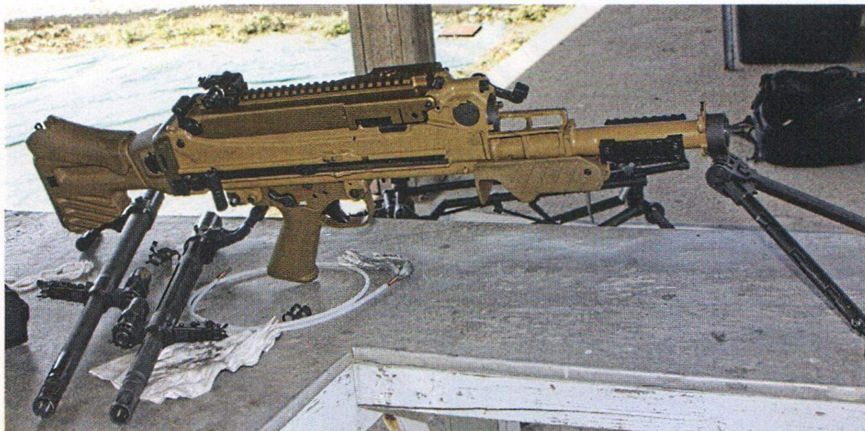
L'arma in smontaggio priva della canna. Sotto la calciatura si vedono le canne da 550 e 460 mm. La più corta è anche fluted.
