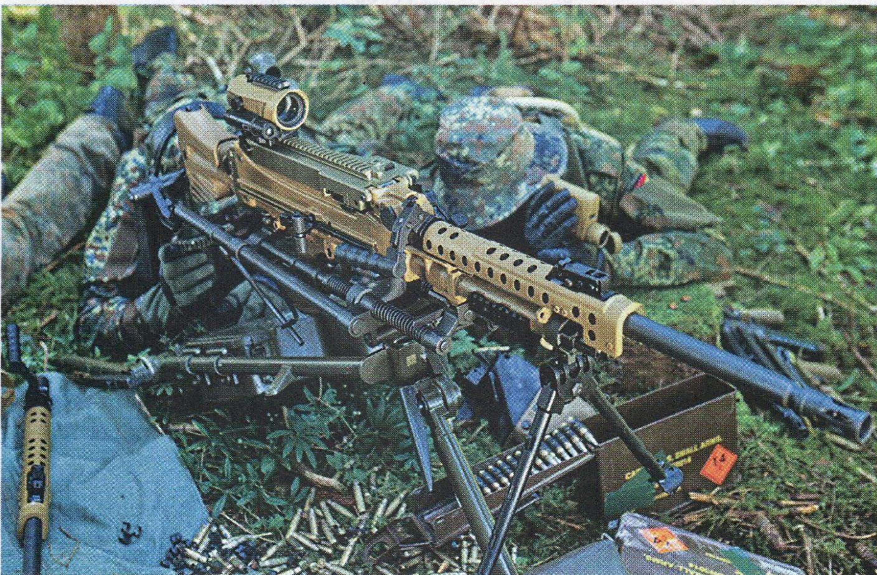
La HK MG-5 è compatibile con gli attacchi ed i treppiedi usati dalle MG-3/MG-42.
