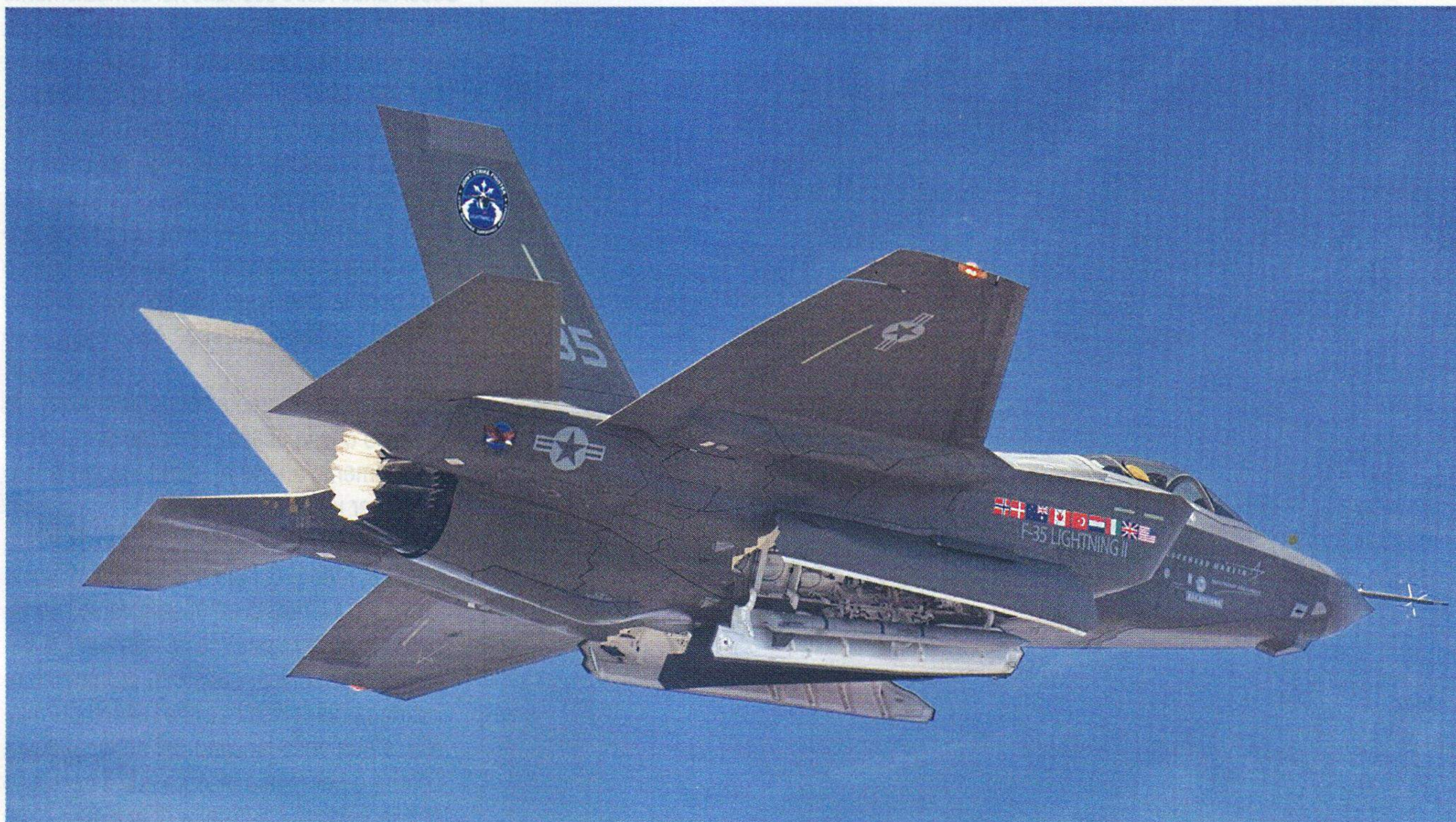
Un F-35 con le 2 baie armamento aperte (notare il missile aria-aria a medio raggio AIM-120).
