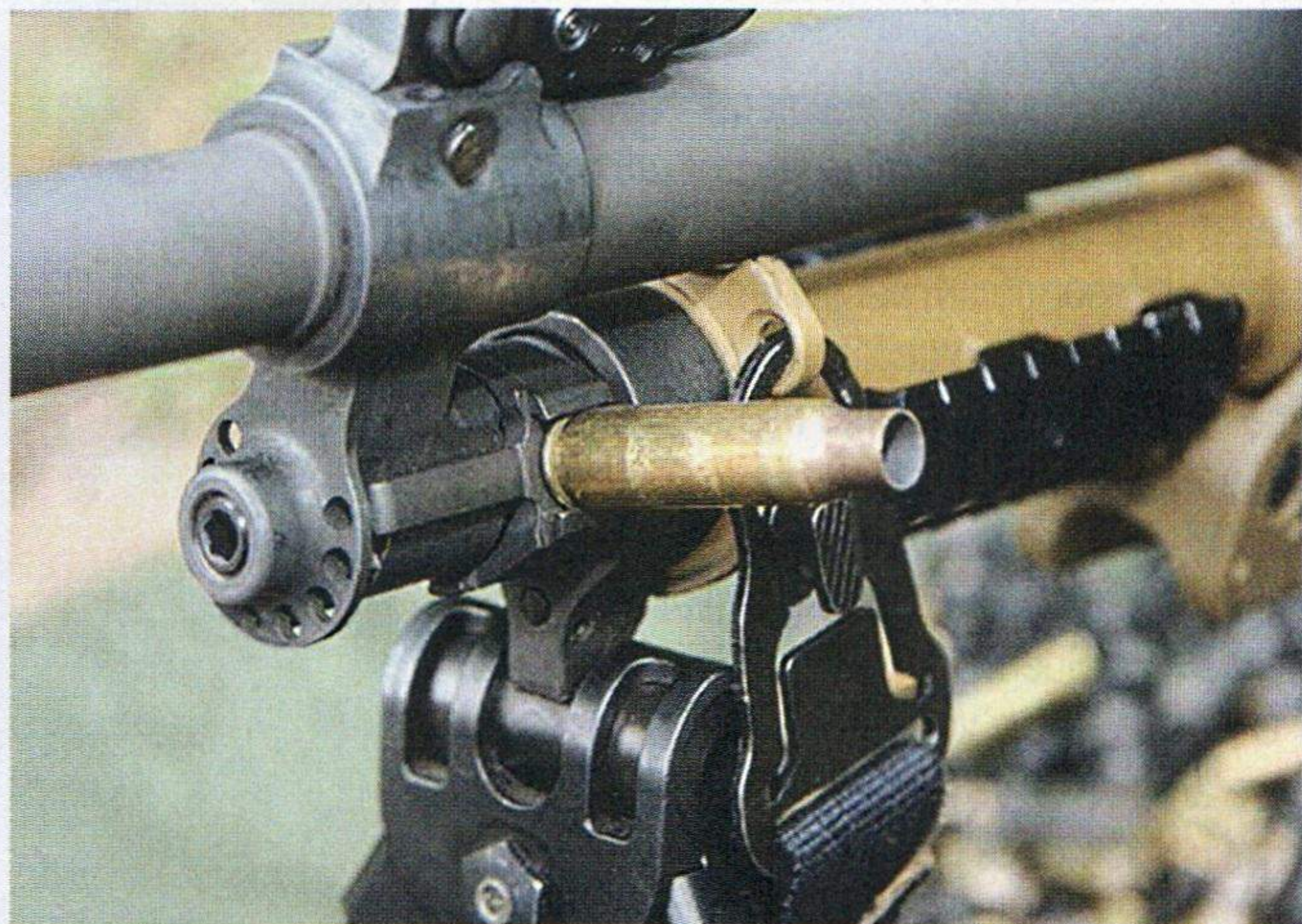
A sinistra: la calciatura in posizione ripiegata sul lato sinistro. A destra: la regolazione del gas (a 3 posizioni) si effettua agganciando all'anello sopra il cilindro il fondello di una cartuccia.
