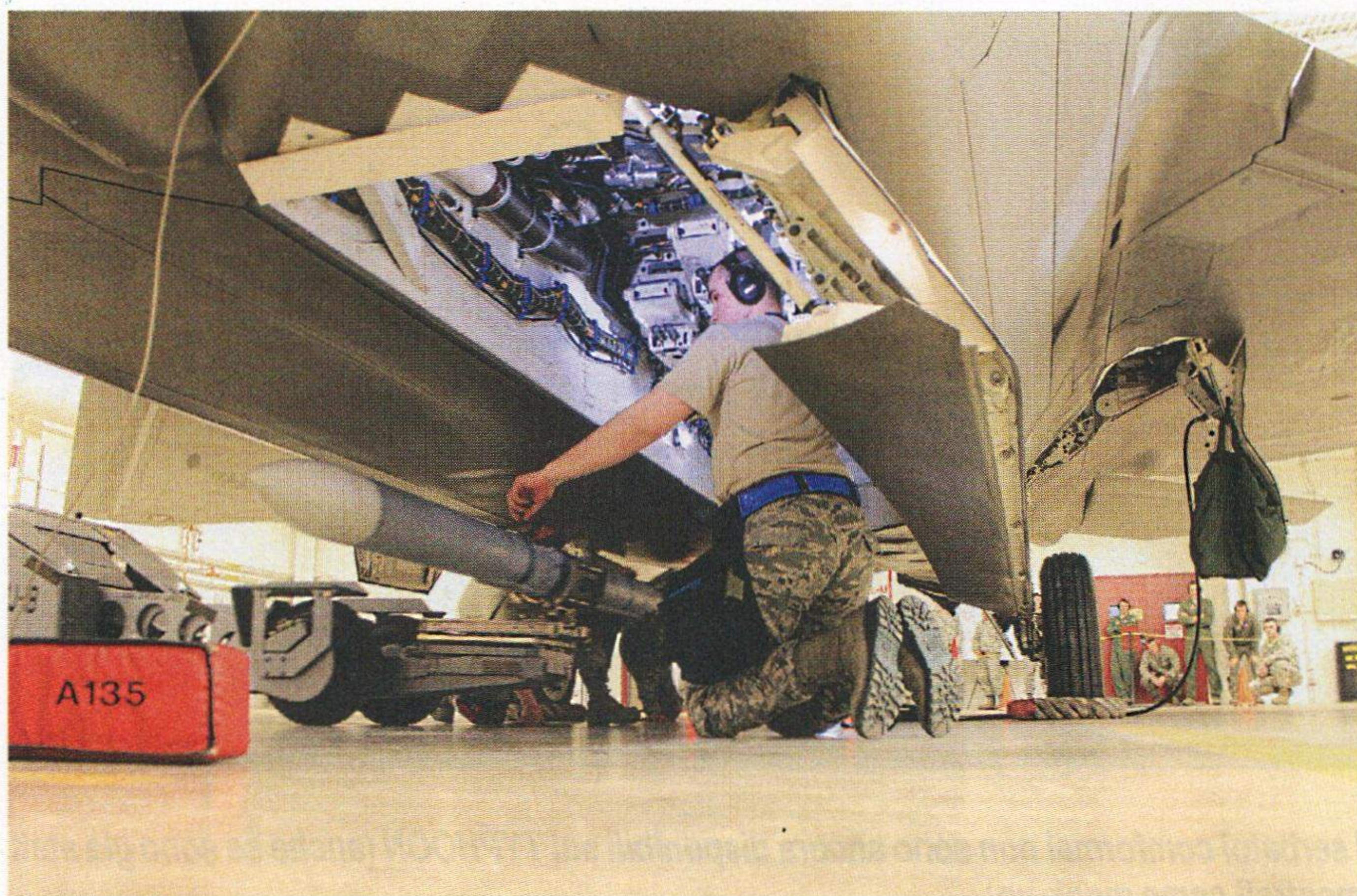
Tecnici dell'USAF si apprestano a caricare un missile aria-aria a medio raggio AIM-120 AMRAAM nel vano armamento di un F-22 RAPTOR.
