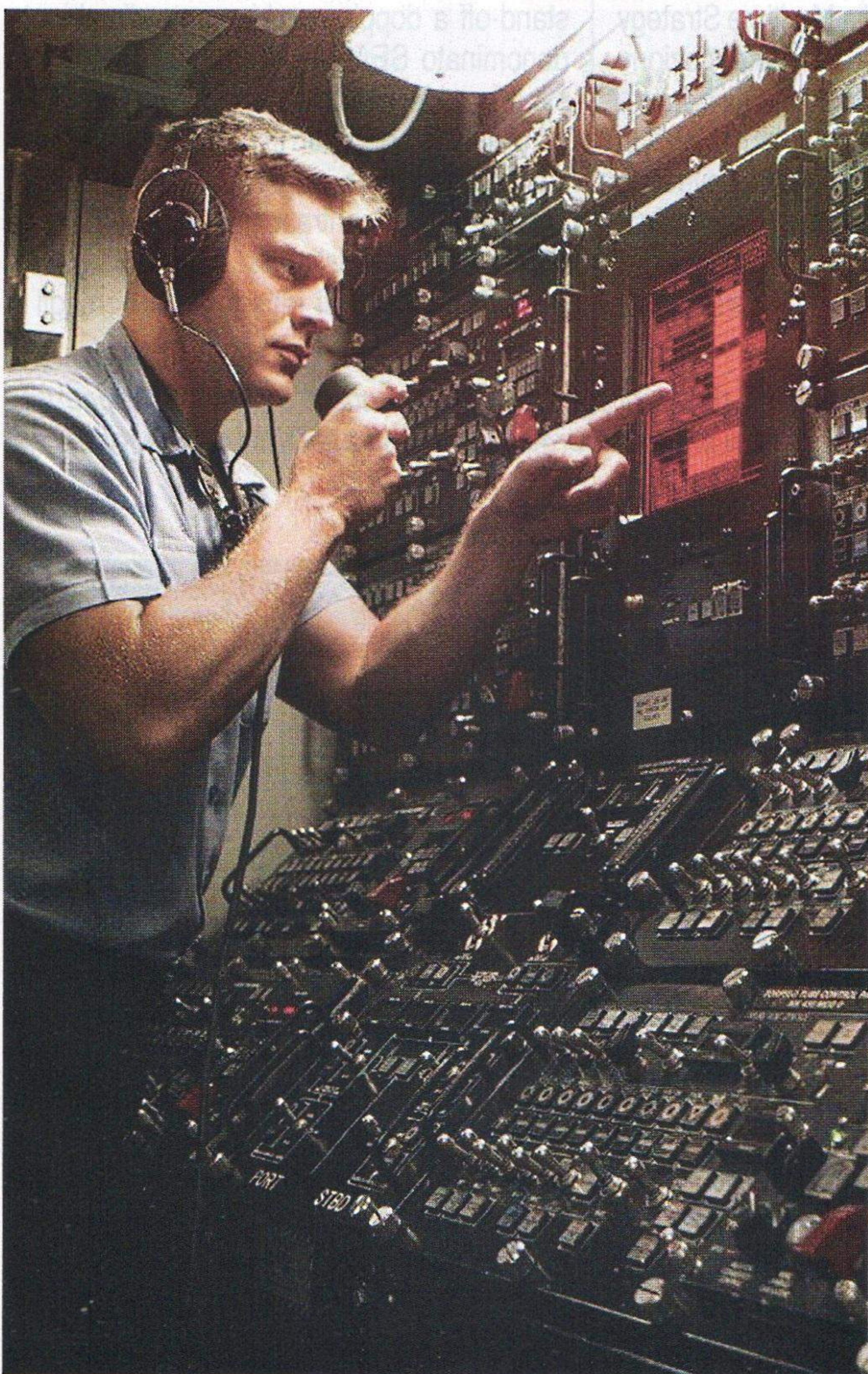
Un operatore in azione sulla consolle "touch screen" per il lancio di ordigni dai tubi lanciasiluri del SEAWOLF: l'operazione avviene normalmente attraverso l'AN/BSY-2, ma una consolle alternativa è sistemata in camera lancio.
