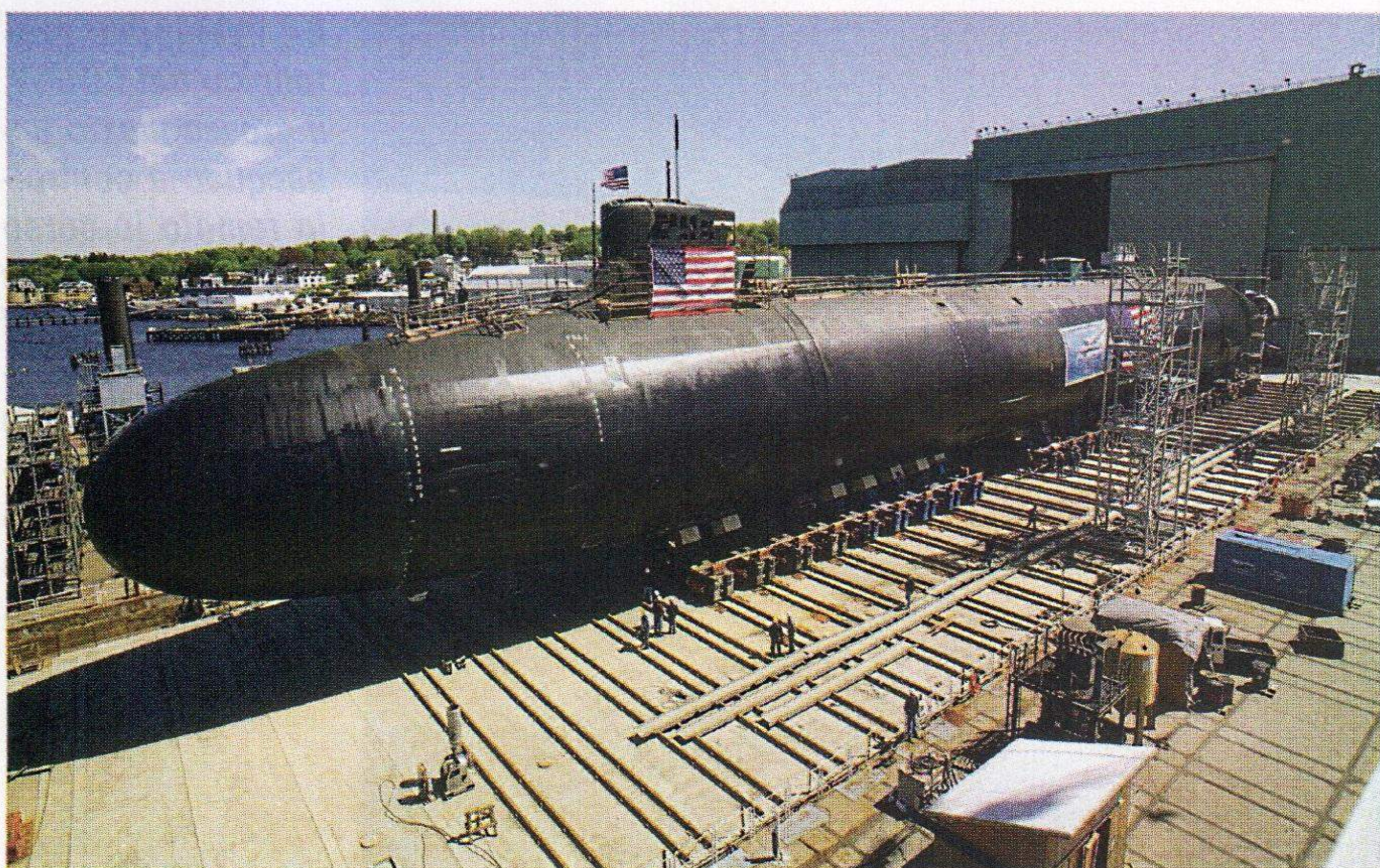
Il roll-out del JIMMY CARTER a Groton: le condizioni di luce durante lo scatto di questa foto permettono di distinguere la sezione aggiuntiva di scafo, inserita poco a poppavia della falsatorre, prima del compartimento dedicato al reattore.
