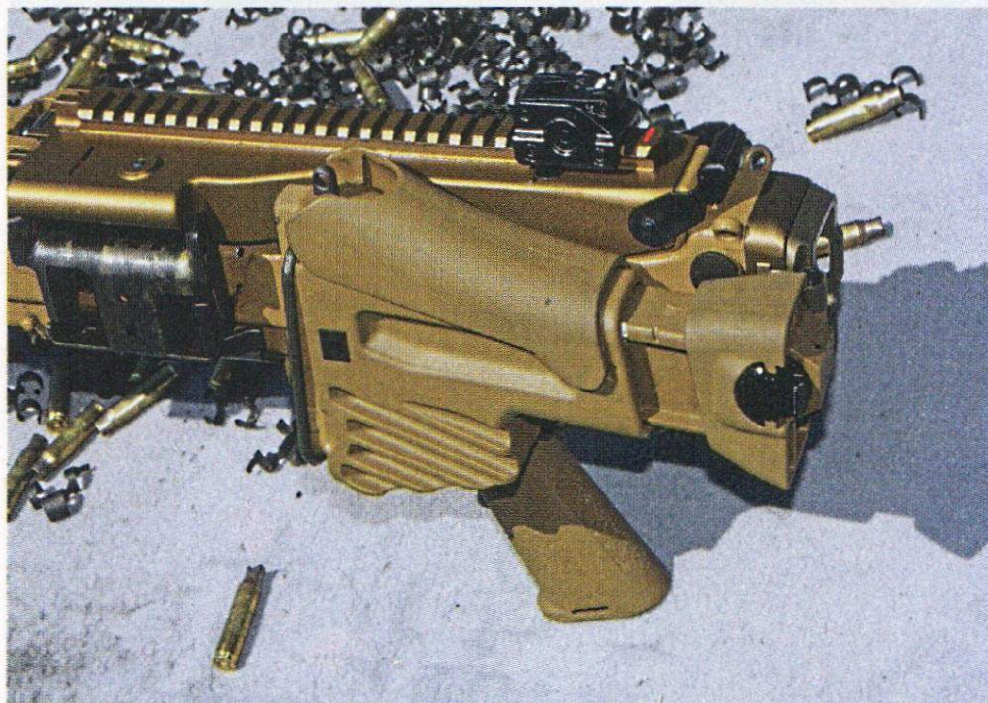
A sinistra: la calciatura in posizione ripiegata sul lato sinistro. A destra: la regolazione del gas (a 3 posizioni) si effettua agganciando all'anello sopra il cilindro il fondello di una cartuccia.
