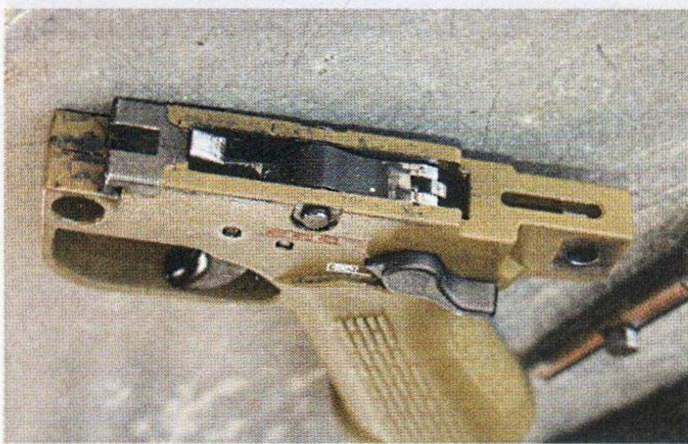
Il gruppo impugnatura è in polimeri e presenta all'interno la leva di scatto.
