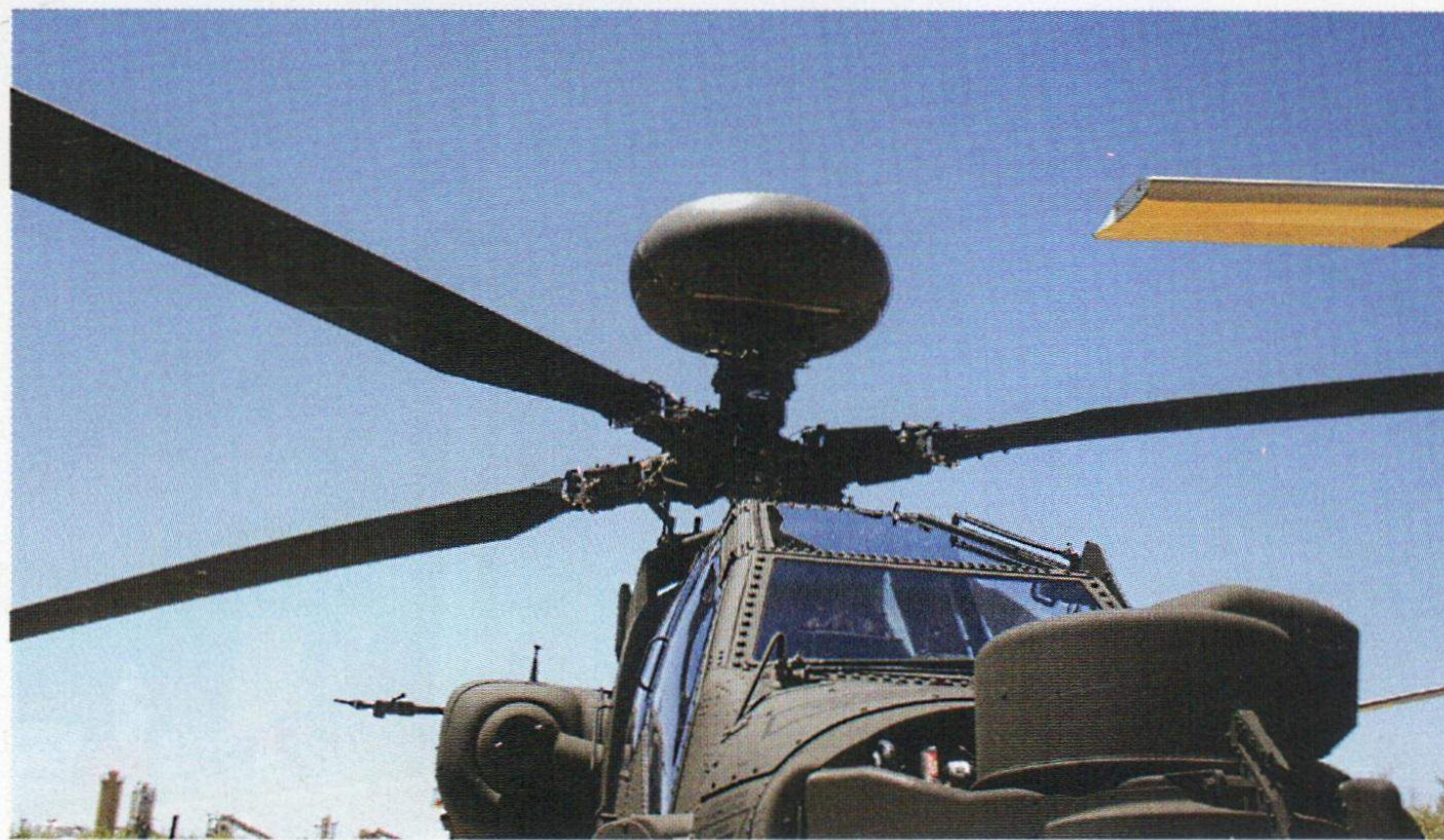
L'introduzione del radar millimetrico LONGBOW ha costituito un vero e proprio spartiacque nel percorso evolutivo dell'AH-64 APACHE.
